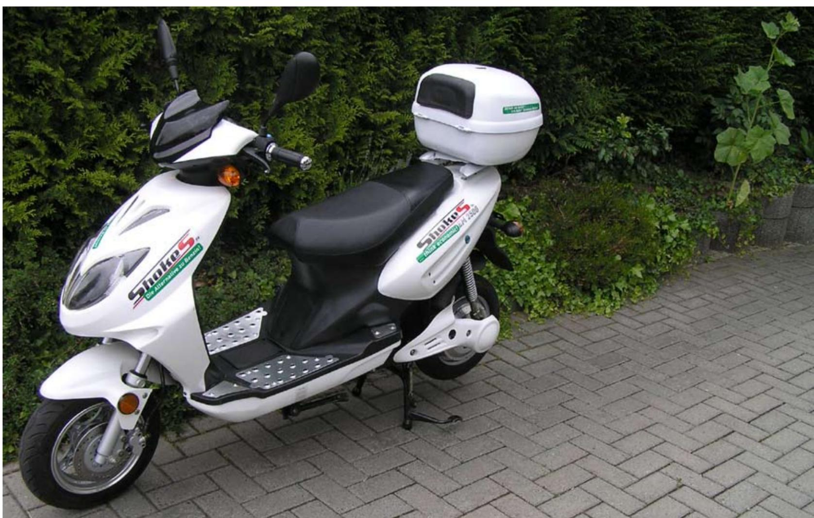
Der „EM2500-LITHIUM“ von Innoscooter kommt mit einer Akkuladung 40 bis 50 Kilometer weit. (T.Grau)
